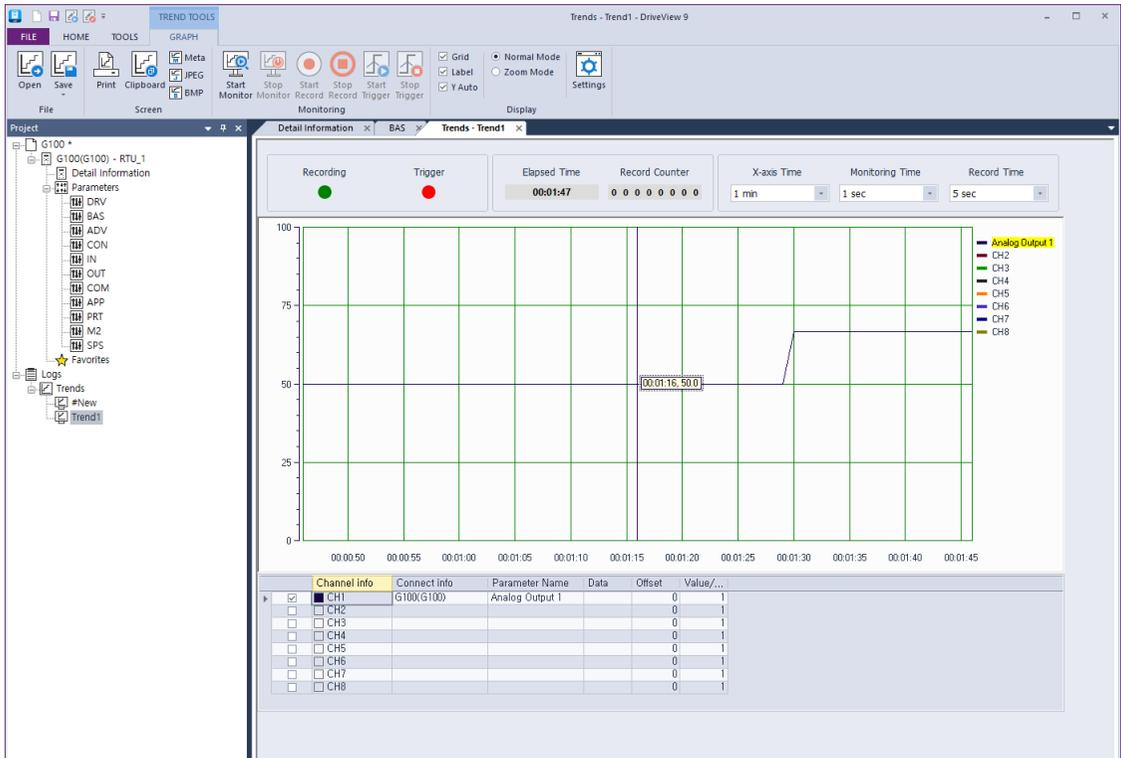
DriveView9의 트렌드 화면에서 모니터링 파라미터를 그래프 형태로 모니터링 할 수 있습니다. 모니터링 그래프는 8개의 채널을 제공합니다. 트렌드는 모니터링, 레코딩, 트리거 관찰 기능을 제공합니다. 상세한 내용은 DriveView9 사용자 설명서를 참조하시기 바랍니다.
