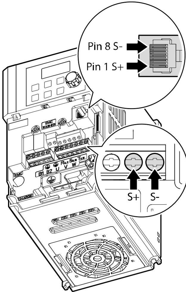
2Pair STP(Shielded twisted Pair)케이블(1번핀 S+, 8번핀 S-만 사용, 1번과 8번핀은 Twisted 형태, 2~7번핀은 사용금지) 및 RJ45 STP 플러그 사용, 제품 간 연결 및 케이블 확장 시에는 RJ45 커플러(STP플러그가 장착될 수 있는 Y형 랜 커플러) 사용(케이블 및 플러그, 커플러는 랜 규격품 사용:CAT5, CAT5e, CAT6)
