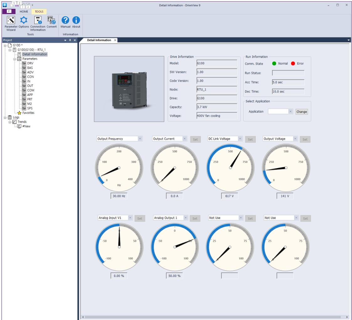
DriveView9의 상세 정보 화면에서 드라이브 정보 및 모니터링 파라미터를 볼 수 있습니다. 1개의 출력 게이지, 7개의 선택 게이지가 제공됩니다. 출력 게이지에서는 출력주파수/속도를 모니터링 할 수 있으며, 선택 게이지에서는 출력 전압, 출력 전류, 아날로그 입력 등의 모니터링 가능 항목을 사용자가 선택하여 게이지 형태로 모니터링 할 수 있습니다. 상세한 내용은 DriveView9 사용자 설명서를 참조하시기 바랍니다.
